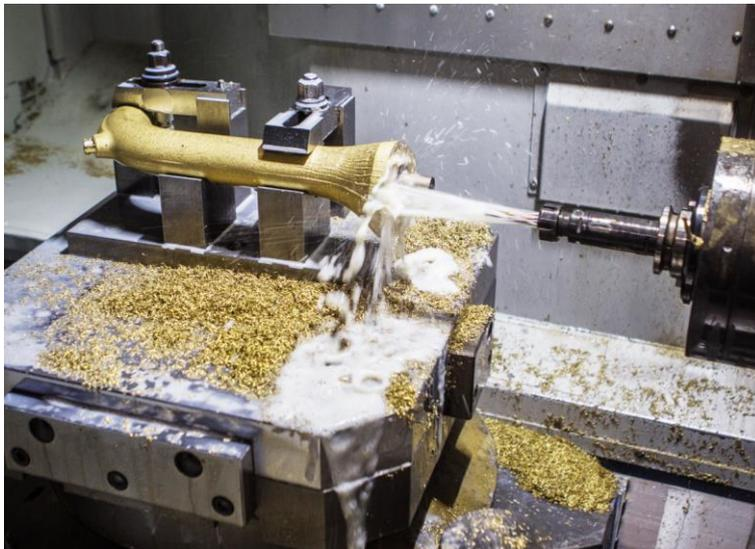
*rhenus TU 446 est adapté à l'acier, l'inox, aux métaux non ferreux, à la fonte et au titane. Exemple : usinage de robinets à bière en laiton.*
